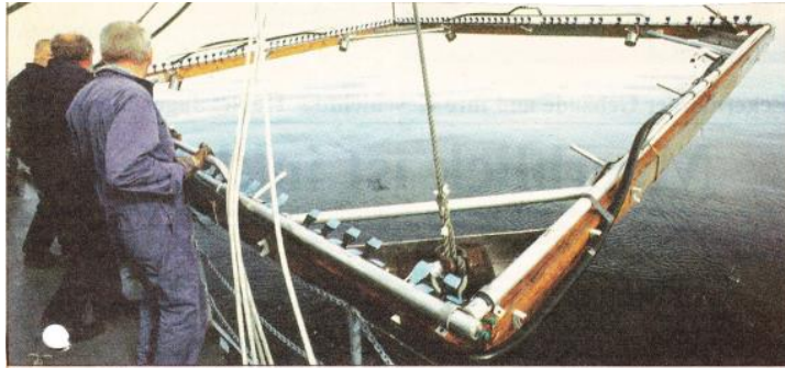
Soll die Druckwelle dämpfen: Die WTD 71 erprobt diesen mit Luftdüsen bestückten Rahmen, der unter Wasser einen Blasenschleier erzeugt.
