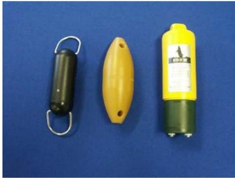
Figure 1 : Les modèles de pingers testés dans notre étude , de gauche à droite : pinger V02, Aquamark 100, DDD02
